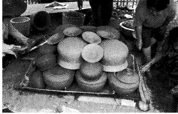
写真10 鍋類を下向きか斜めに積む
