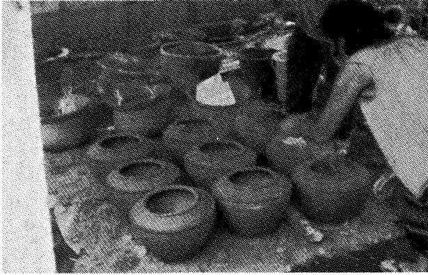
写真 09 水甕を直立して方形に設置し、周囲と間に薪を置く。
