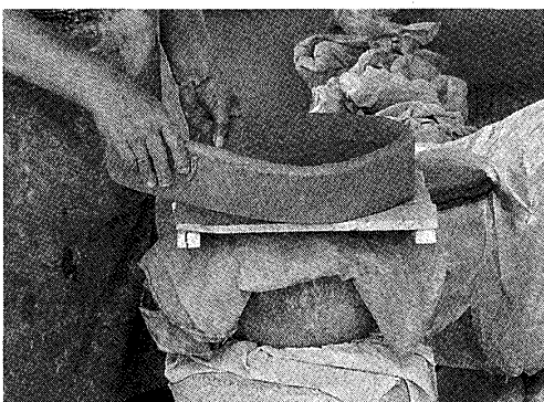
写真21 1段目の粘土帯を底部円板の外側に巻きつける
