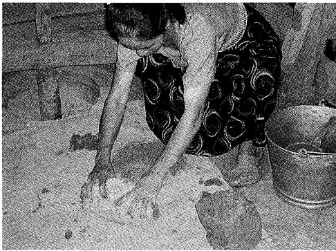
写真 51 粉末粘土に水を掛けて手練り
