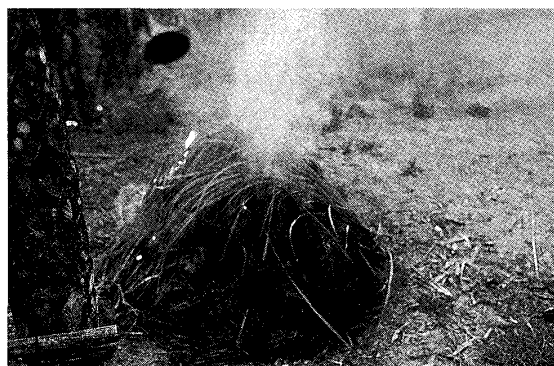
写真 77 被覆材の生草を掛けて覆いの穴を埋める
