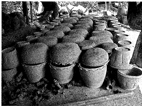
写真43 野焼きにおける土器と竹燃料の設置
