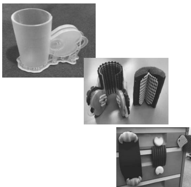
(図3) 3Dプリンターで作成した自助具
