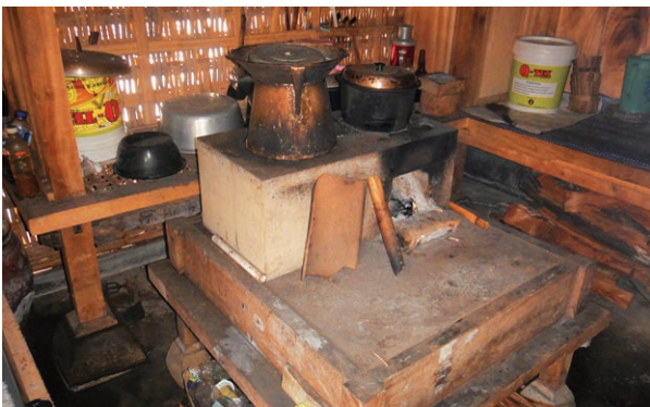
写真15 バリの伝統的な2穴カマド パンリプラン
